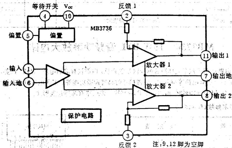
图 2 MB3736 的电路方框图
