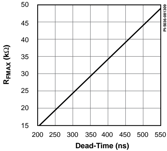
图 14. 从FMAX引脚到VREF引脚的上拉电阻与死区时间要求的比例关系
