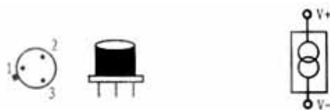
图 1 AD590 的外形电路 图 2 集成温度传感器电路符号
