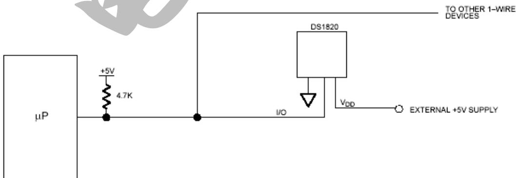
图 3 使用  $V_{DD}$  供温度变换所需电流
