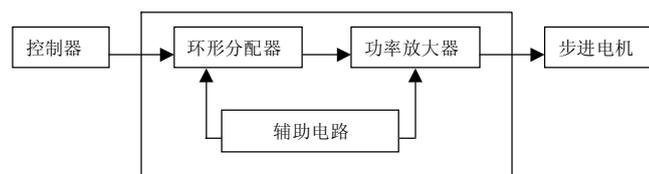
图 1 典型步进电机控制框图
