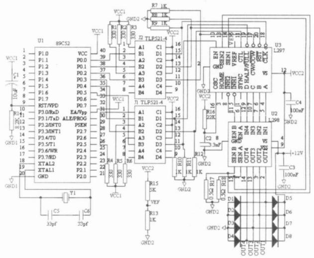
图3 步进电机控制驱动器部分原理图
