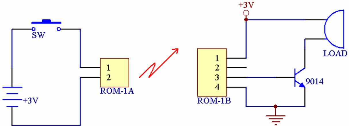
上图为单通道遥控电路，当按下 SW 时，ROM-1A 模块内低频震荡器产生低频信号，并对超高频震荡器产生的超高频信号进行调制，然后通过集成在模块内的微型天线发射出去。ROM-1B 模块内的微型天线在接收到遥控信号后经内电路解调、放大、检波、延时、转换后，从 2 和 3 脚输出，使三极管导通，驱动负载动作。
