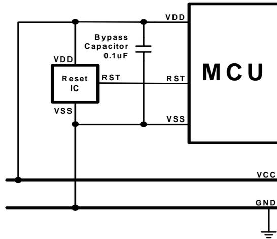
外部复位也可以选用 IC 进行外部复位，但是这样一来系统成本将会增加。针对不同的应用要求选择适当的复位 IC，如上图所示外部 IC 复位电路，能够有效的降低电源变化对系统的影响。
