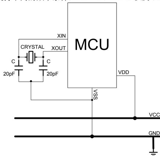
\* 注：上图中，XIN/XOUT/VSS 引脚与石英/陶瓷振荡器以及电容 C 之间的距离越近越好。
