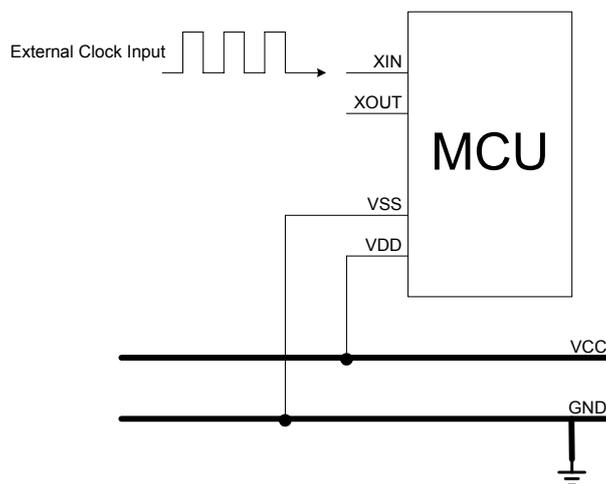
\* 注：外部振荡电路中的 GND 必须尽可能的接近单片机的 VSS 端口。
