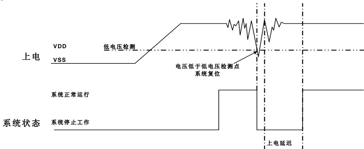
低电压检测（LVD）是 SONiX 8 位单片机内置的掉电复位保护装置，当 VDD 跌落并低于 LVD 检测电压值时，LVD 被触发，系统复位。不同的单片机有不同的 LVD 检测电平，LVD 检测电平值仅为一个电压点，并不能覆盖所有死区范围。因此采用 LVD 依赖于系统要求和环境状况。电源变化较大时，LVD 能够起到保护作用，如果电源变化触发 LVD，系统工作仍出错，则 LVD 就不能起到保护作用，就需要采用其它复位方法。
