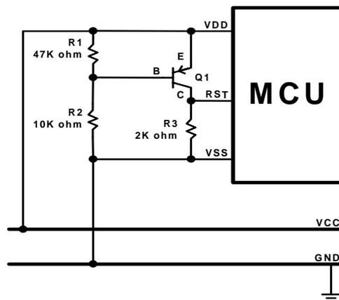
电压偏置复位电路是一种简单的 LVD 电路，基本上可以完全解决掉电复位问题。与稳压二极管复位电路相比，这种复位电路的检测电压值的精确度有所降低。电路中，R1 和 R2 构成分压电路，当 VDD 高于和等于分压值“ $0.7V \times (R1 + R2) / R1$ ”时，三极管集电极 C 输出高电平，单片机正常工作；VDD 低于“ $0.7V \times (R1 + R2) / R1$ ”时，集电极 C 输出低电平，单片机复位。
