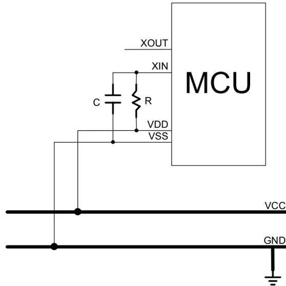
\* 注：电容 C 和电阻 R 应尽可能的接近单片机的 VDD。
