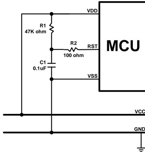
上图为一个由电阻 R1 和电容 C1 组成的基本 RC 复位电路，它在系统上电的过程中能够为复位引脚提供一个缓慢上升的复位信号。这个复位信号的上升速度低于 VDD 的上电速度，为系统提供合理的复位时序，当复位引脚检测到高电平时，系统复位结束，进入正常工作状态。
