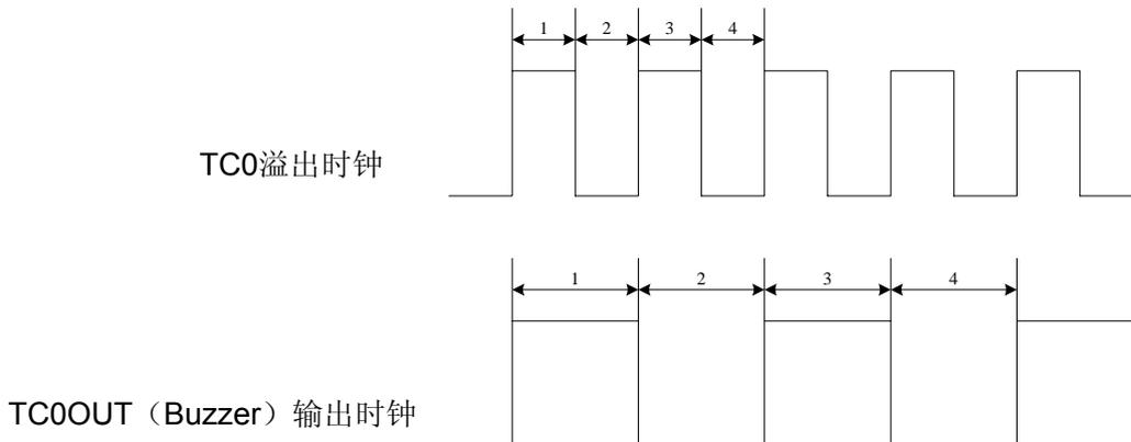
若外部高速时钟选择 4MHz，系统时钟源采用外部时钟  $F_{osc}/4$ ，程序中设置  $TC0RATE2 \sim TC0RATE1 = 110$ ， $TC0C = TC0R = 131$ ，则 TC0 的溢出频率为 2KHz，TC0OUT 的输出频率为 1KHz。下面给出范例程序。
