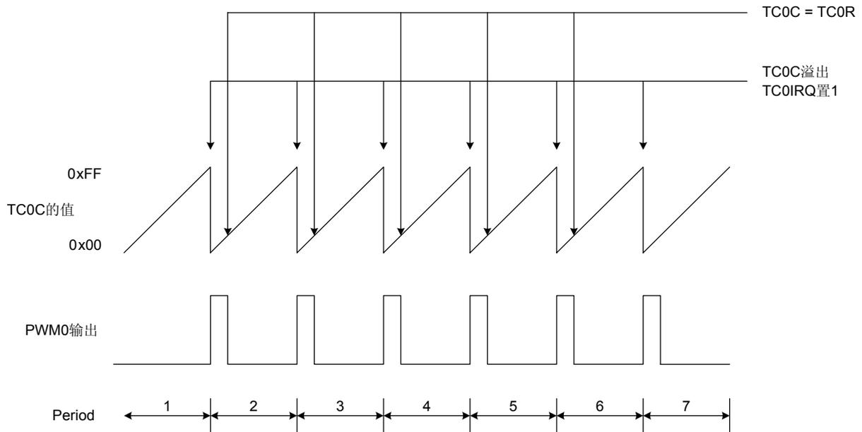
上图所示是 TC0R 恒定时的波形。每当 TC0C 溢出时，PWM 都输出高电平， $TC0C \geq TC0R$  时，PWM 即输出低电平。下面所示是 TC0R 发生变化时对应的波形图：
