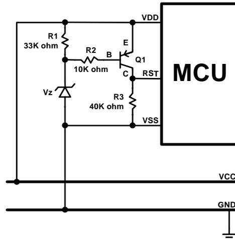
稳压二极管复位电路是一种简单的 LVD 电路，基本上可以完全解决掉电复位问题。如上图电路中，利用稳压管的击穿电压作为电路复位检测值，当 VDD 高于“ $V_z + 0.7V$ ”时，三极管集电极输出高电平，单片机正常工作；当 VDD 低于“ $V_z + 0.7V$ ”时，三极管集电极输出低电平，单片机复位。稳压管规格不同则电路复位检测值不同，根据电路的要求选择合适的二极管。
