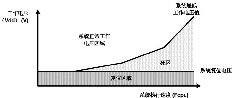
系统工作电压与执行速度关系图
