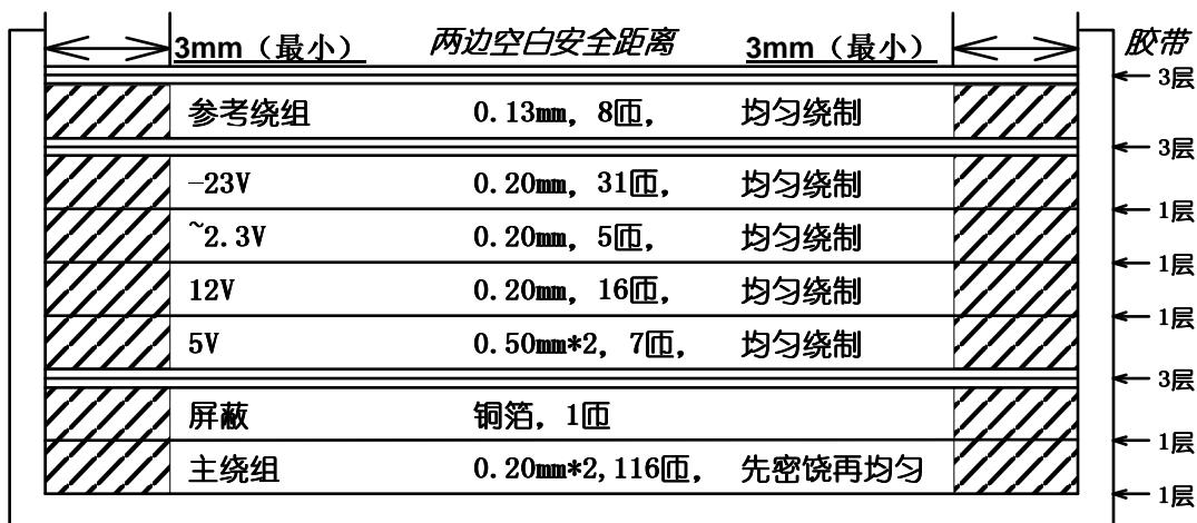
图 5、例 2, T1,EEL19,1mH 变压器结构
