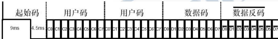
使用 455KHz 晶振时各代码所占的时间
