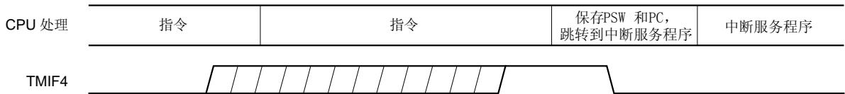
图 15-11. 不可屏蔽中断请求响应
