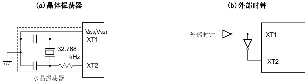
图 5-6. 副系统时钟振荡器外部电路
