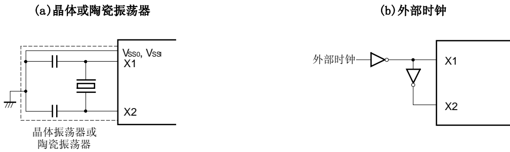
图 5-5. 主系统时钟振荡器的外部电路
