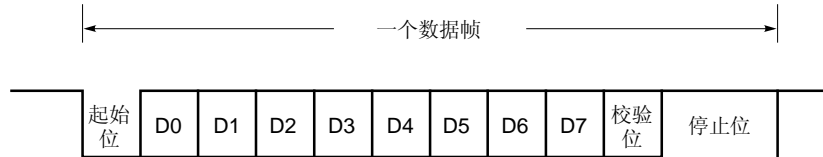
图 13-7. 异步串行接口发送/接收数据的格式
