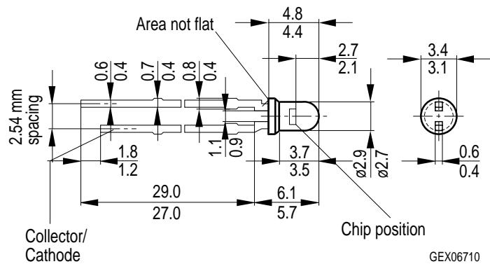
**Kathodenkennzeichnung:** Kürzerer Lötspieß**Cathode mark:** Short solder lead
