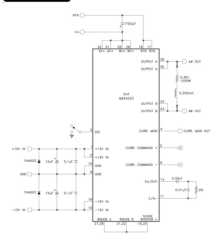
TYPICAL TEST SCHEMATIC
