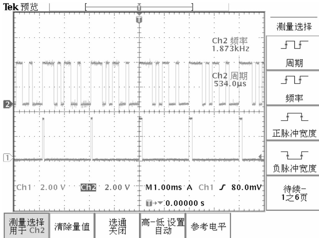
通道1为 SYNC，通道2为接收端伪码输出，我们可以清楚地看到后三个同步后的输出。
