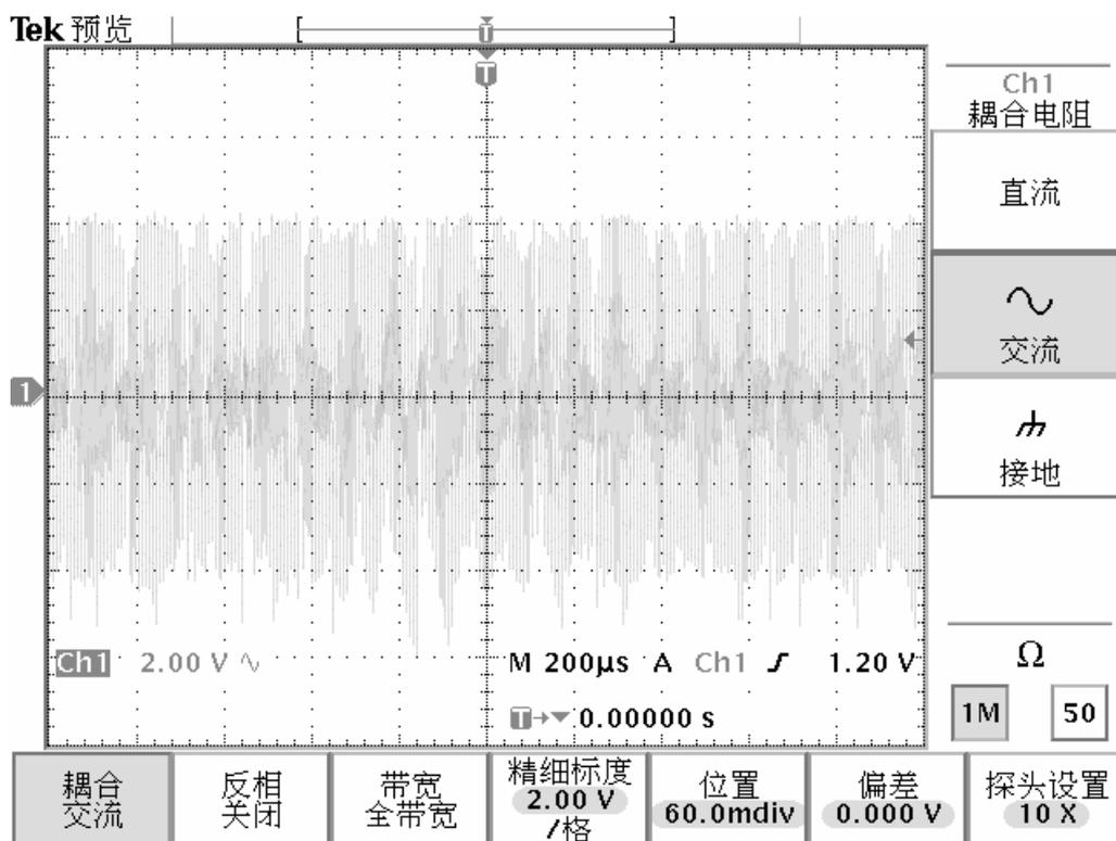
通道1为 PL2102 DEMO 板耦合线圈输入信号 (施加宽带干扰源)。
