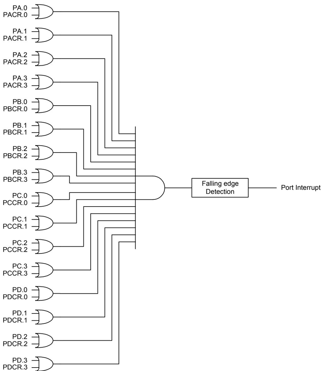
图 6 端口中断功能框图
