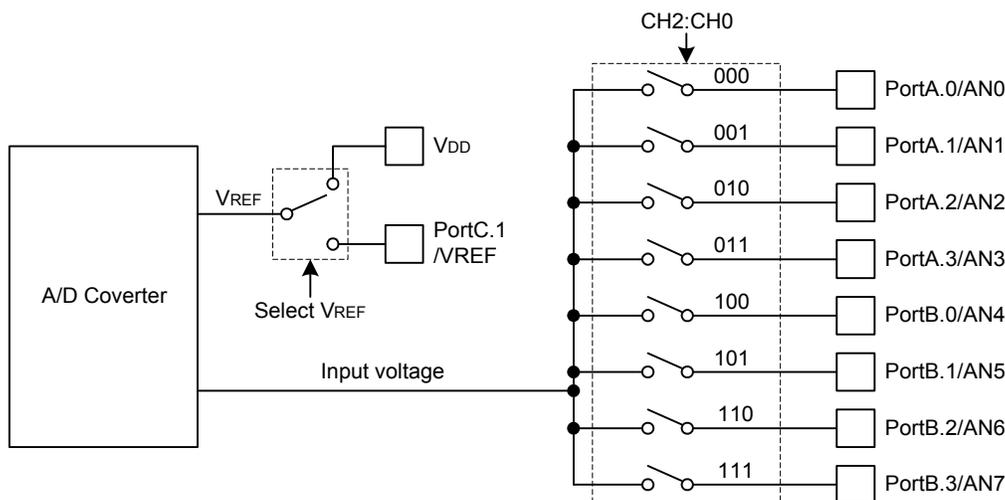
图 1 A/D 转换框图
