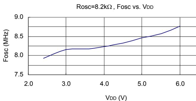
(c) 典型的内部 RC 振荡器频率稳定性与工作电压关系图: (仅供参考)
